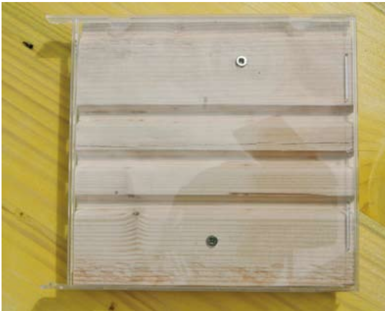
Abb. 4: Jetzt wird die CD-Hülle mit zwei Spax-Schrauben (2,5 x 10 mm) festgeschraubt.
