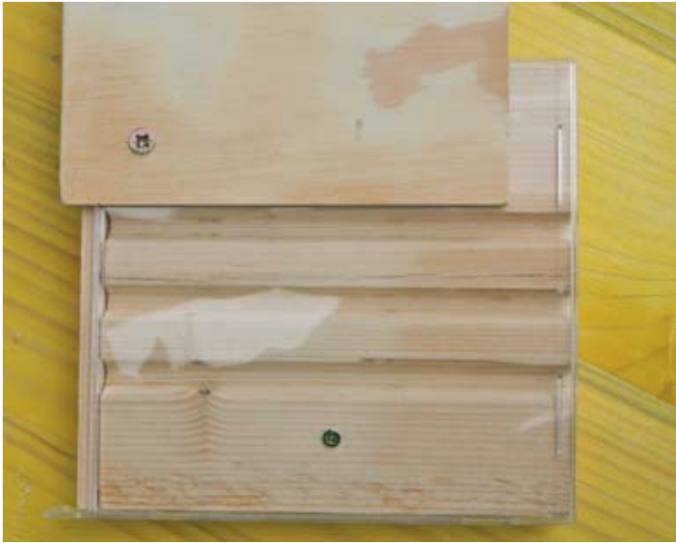
Abb. 7: Die Abdeckplatte wird mit einer Spax-Schraube (4 x 16 mm) fixiert. Im Prinzip ist der aufgeklappte Beobachtungskasten jetzt bereits fertig.
