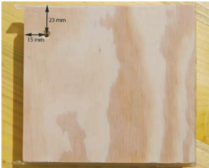
Abb. 6: Nun wird die Sperrholzplatte bündig aufgelegt und exakt in der linken oberen Ecke im Abstand von 15 mm von links und 23 mm von oben durchbohrt (D 4 mm). Durch Sperrholzplatte und CD-Hülle bis ins Dielenstück bohren und Bohrloch leicht fräsen.
