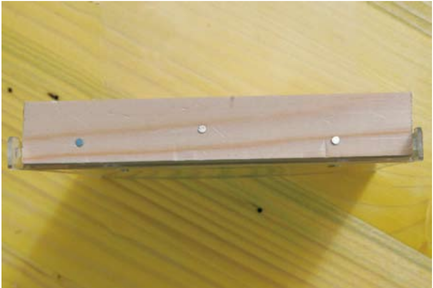
Abb. 5: Als nächstes wird die Sperrholzleiste (20 x 120 mm) als hintere Abdeckung angenagelt. Beim Ansetzen der Nägel die Falzhohlräume meiden!
